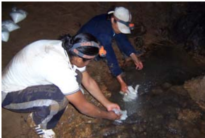
Foto 14. Disolución del Cloruro de Sodio en el interior de la Cueva del Agua y medición de Sólidos Disueltos Totales SDT, en el manantial “El Higuierón”. 23 de Febrero de 2008. EXCAV-COBAQ 13.
