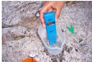
Foto 14. Disolución del Cloruro de Sodio en el interior de la Cueva del Agua y medición de Sólidos Disueltos Totales SDT, en el manantial “El Higuierón”. 23 de Febrero de 2008. EXCAV-COBAQ 13.
