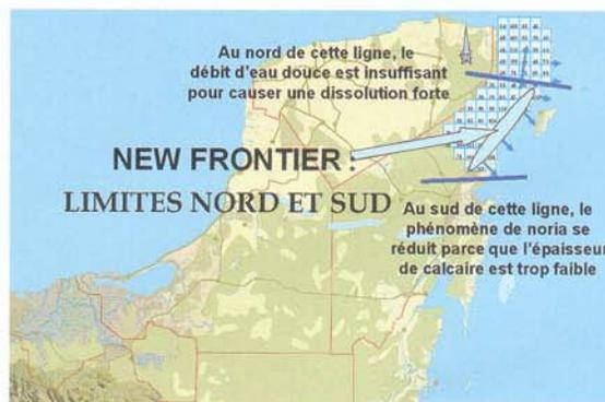
Figure 25 : Limite nord et sud de la « New Frontier » où se concentrent tous les grands réseaux noyés de la péninsule. Au nord, le débit d'eau douce est insuffisant pour causer une dissolution forte, et au sud le phénomène de noria thermique se réduit avec l'épaisseur des calcaires.
